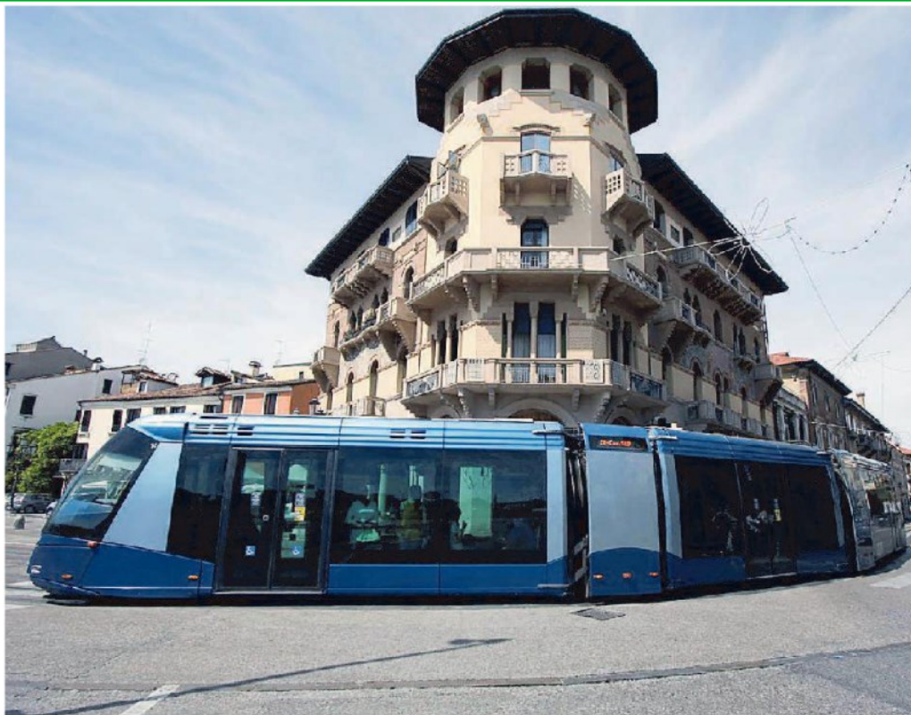
La prima linea del tram al suo ingresso in Prato della Valle dove va a batteria, senza pantografo
