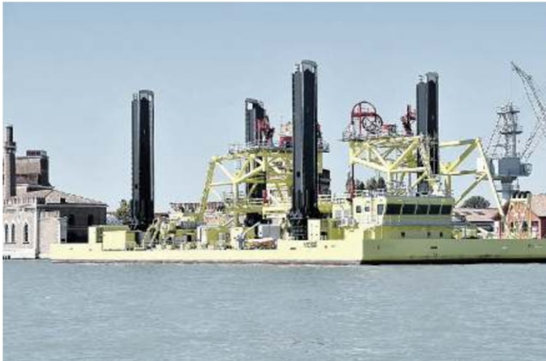
VENEZIA II jack up sarà usato per la movimentazione delle paratoie
