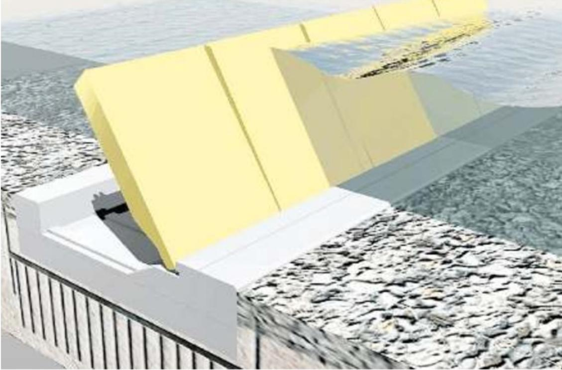
**SIMULAZIONE** La riproduzione del funzionamento delle dighe mobili in caso di marea fuori norma
