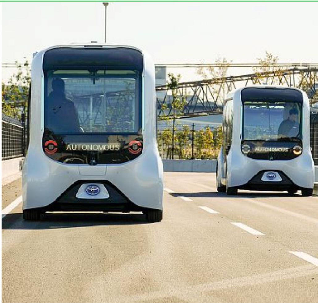
l'e-Pallette è un veicolo a guida autonoma dotato di display per interagire con i pedoni
