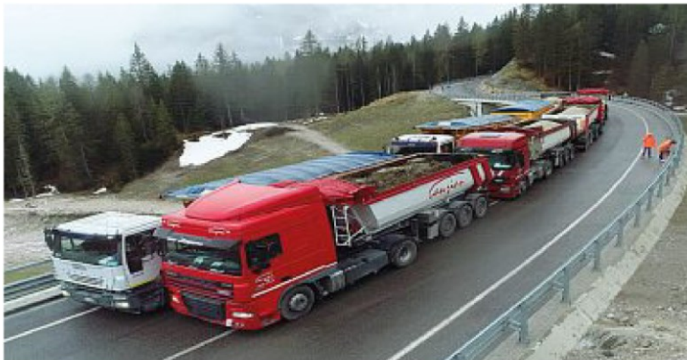
Prove di carico Il ponte sul torrente Rudavoi, lungo la Sr 48 di Cortina durante le prove di carico con 8 tir
